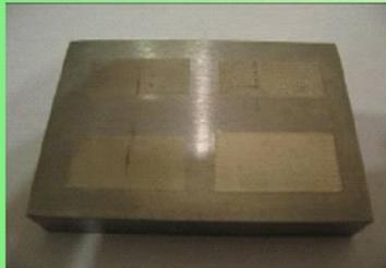
Пример материала, который использовался для разработки метода: образец сделан из титана с 4 различными зонами
