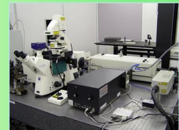
Устройство лазерной сканирующей микроскопии
